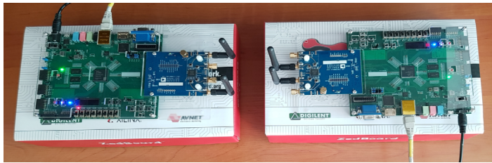
Сурет 6 – Қабылдағыш-таратқыштың аппараттық бөлігі
