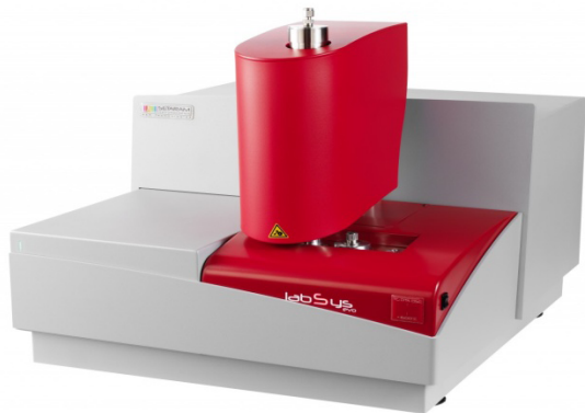
Сурет 2– LabSys Evo термиялық талдағышы
