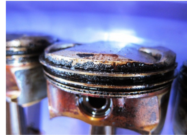
Рисунок 2 – Последствие образования нагара на порше
