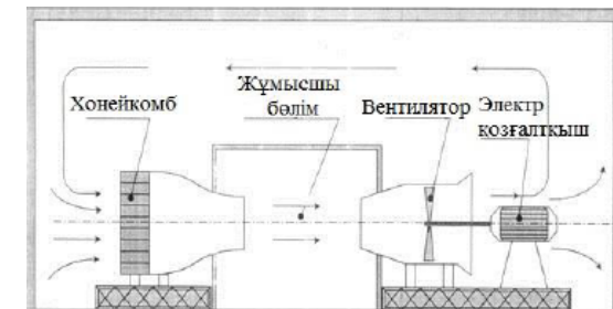
Сурет 2 – АҚ «Гидроприбор» ғылыми- зерттеу институтының аэродинамикалық трубасының схемасы
