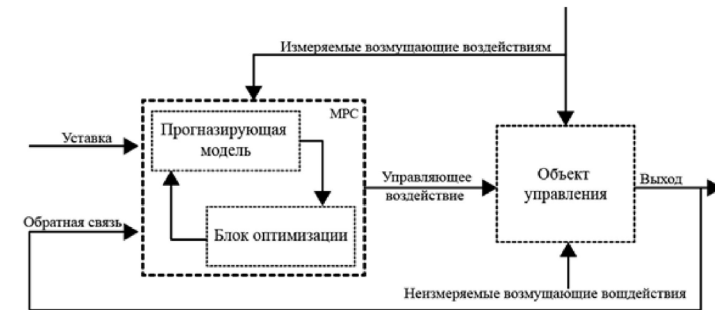
Рисунок 2 – Структурная схема MPC регулятора
