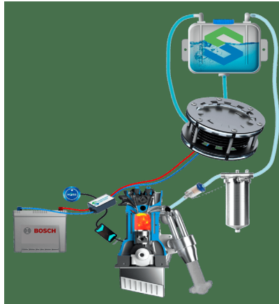
Рисунок 1 – Система водородного питания двигателя
