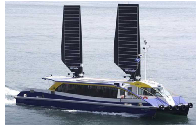
Рисунок 2 – Внешний вид судна Suntech VIP компании «Solar Sailor»
