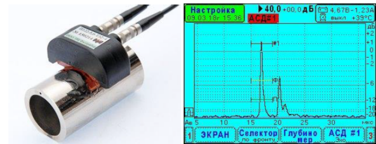
Рисунок 1 – Хордовая схема сканирования. Настройка на стандартный образец предприятия с плоскостным отражателем.
