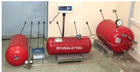
Сурет 3 – эксперименттік қондырғының жалпы түрі 1 – сығылған табиғи газы бар баллон; 2 – ДКП–1–65 редуктор; 3 – аккумуляторлық батарея; 4 – арынды магистраль; 5 – МИДЛ–П 150 едендік таразылар; 6 – көлемі 50 л автомобильдік газ баллоны; 7 – мультиклапан; 8 – СУГ ағызу магистралі; 9 – көлемі 130 л төгу резервуары; 10 – манометр
