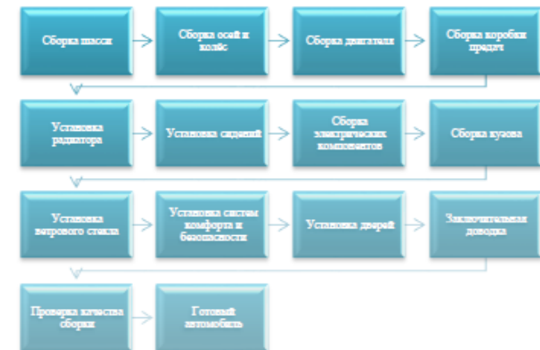
Рисунок 1 – Упрощённая блок-схема сборочного процесса на заводе «Такаока», Япония
