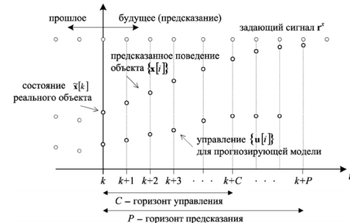
Рисунок 1 – Графическое представление управления с помощью MPC- регулятора
