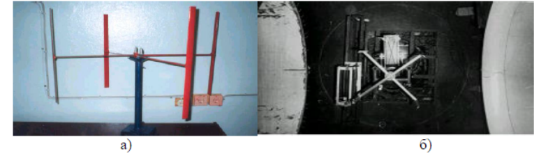
Сурет 1 – Қос роторлы, Бидарье жел турбинасының лабораториялық моделі. а) бүйірінен түсірілген. б) АҚ «Гидроприбор» ғылыми-зерттеу институтының аэродинамикалық трубасының төбесінен түсірілген көрініс. Орал қаласы
